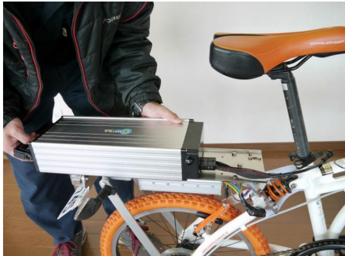
①バッテリーを車体から取り外します。
