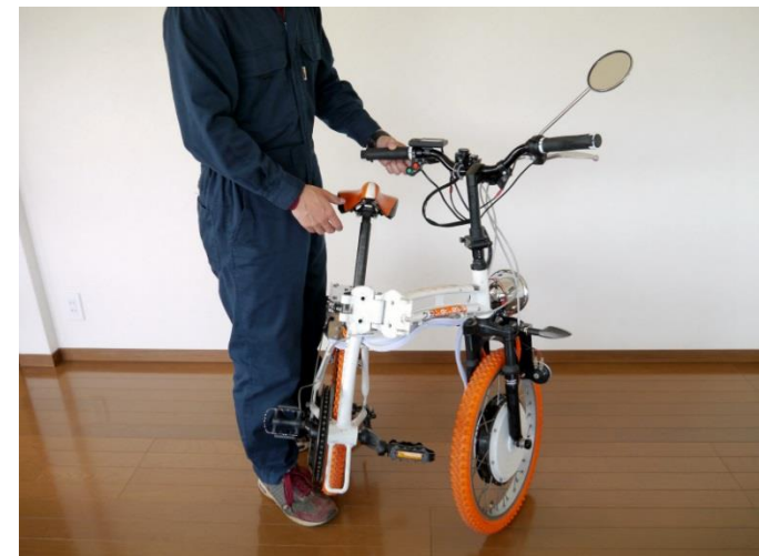
④車体を折りたたみます。(ブレーキを握りながら折りたたむと、車体が動かずスムーズです。)
