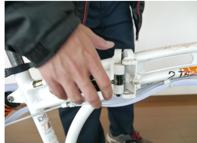
③クイックリリースレバーを持ち上げて、ジョイントから外します。
